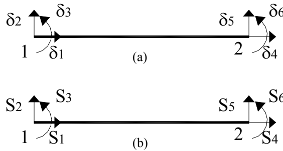
Figura 10. Desplazamientos y solicitaciones en una barra.
