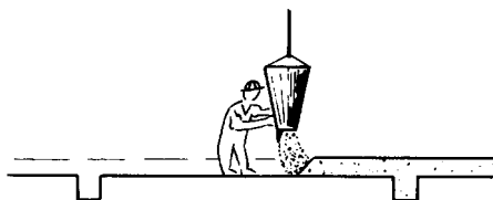
Figura 43: Ejecución correcta del hormigonado.
