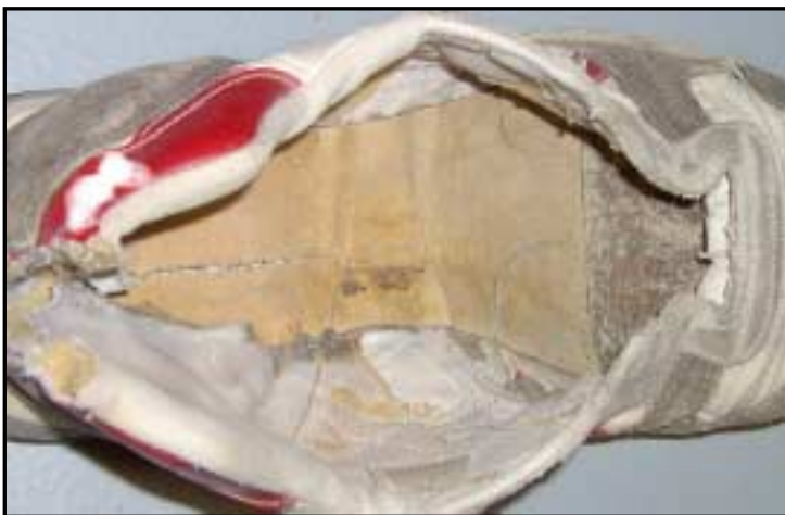
Hormado mixto con convencional detrás y completo delante.
